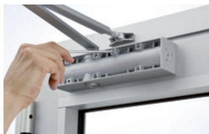
Plynule nastavitelná rychlost zavírání, dovírání dveří a maximálního úhlu otevření (back-check) pomocí ventilů umístěných na čelní straně zavírače
