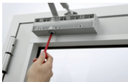
Výškově nastavitelná osa ramínka (rozsah do 14 mm) kromě DC120, DC140
